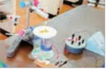
今回着目したサボニス型風車は小さい風で発電できる一方、発電量が少ないというデメリットがある。今回の実験では、風速ごとに最適なギア比が異なることが明らかとなり、地球温暖化抑制につながる新たなエネルギーの活用には有意義な知見が得られた。
